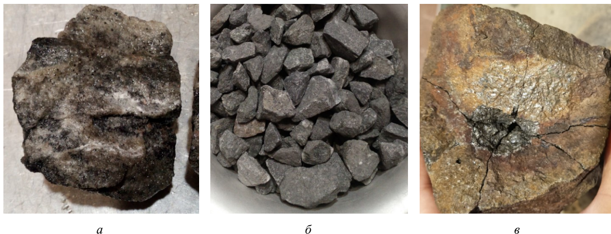
Рис. 1. Образцы горных пород и шлака, подвергнутые электроимпульсному воздействию: а — апатит-нефелиновая руда; б — железная руда; в — шлак медно-никелевого производства Fig. 1. Samples of rocks and slag subjected to electric pulse treatment: a — apatite-nepheline ore; b — iron ore; c — slag of copper-nickel production
